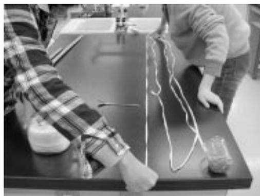
納豆(右端)から伸びる糸の長さを、ひもを使って測定している様子
